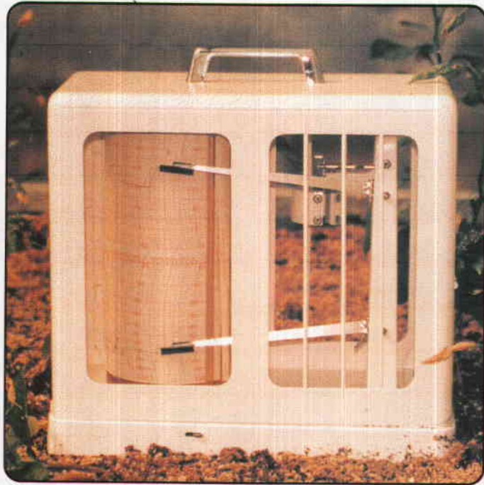
صورة رقم (4) مسجل الحرارة والرطوبة النسبية الضرورى تواجده فى البيوت المغطاة المبردة
